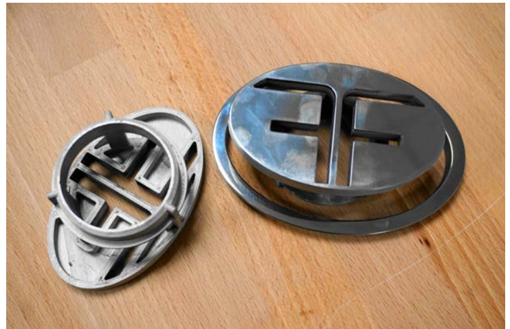
Deze afdekplaat is op de Metal X geprint met de nieuwe 316 legering die ongevoelig is voor de inwerking van zeewater. Markforged moet dit materiaal nog vrijgeven.
